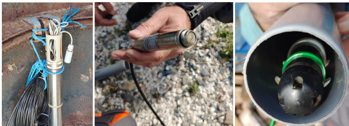
Înregistrator digital – echipament (stanga) și senzor de presiune (central și dreapta)
