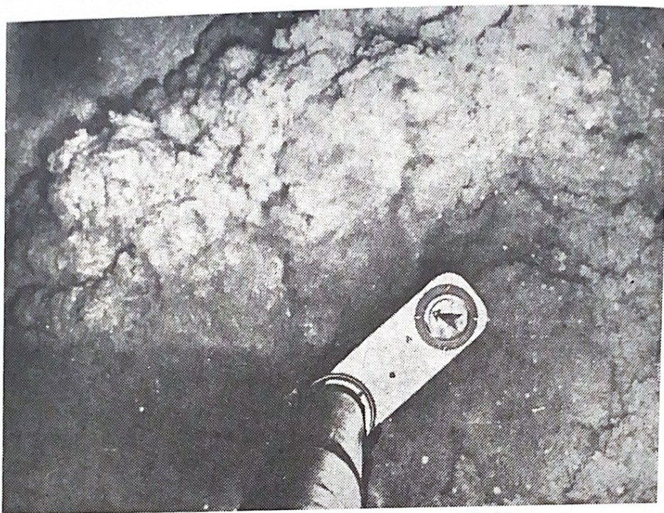
Fig. 4.45 Fotografia fundului mării făcută de un aparat montat în setul de greutate al unui carotier cu piston. Norul mare de sediment a fost generat de pătrunderea carotierului în sedimentele de fund. De observat busola și clinometrul montate pe tubul carotierului pentru a marca poziția acestuia care, în acest moment a pătruns cu aproximativ 25 ft în sediment. Direcția deplasării norului de sediment furnizează informații asupra curenților de fund (Fotografie oferită de F. McCoy).
